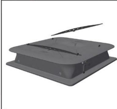
Step 1: (Remove Lid Pins)
